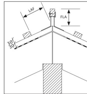
LAF = Lattenabstand zum Firstschnittpunkt (in mm)
